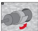
3 Envolver a Banda Intumescente CFS-B em redor do isolamento. Fixar a fita com bandas metálicas ou arame ( $\geq 0,7$  mm).
