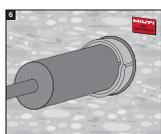
6 Caso seja necessário, aplicar uma camada adicional de isolamento sobre a Banda Intumescente CFS-B. Colocar uma placa de identificação ao lado da selagem, se exigido.
