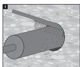
1 Limpar a abertura. O material à volta da abertura deve estar seco, em boas condições e livre de pó e gordura.
