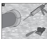
5 Fechar o espaço anelar em falta com Espuma Expansiva Intumescente Hilti CFS-F FX.
