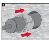
4 Instalar a Banda Intumescente CFS-B em ambos os lados da abertura com uma profundidade de 62,5 mm (ver marcação na fita).
