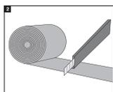
2 Cortar a Banda Intumescente CFS-B de modo a revestir o diâmetro externo do isolamento do tubo. Garantir duas camadas e uma sobreposição entre elas.
