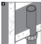
d) Colocar uma placa de identificação ao lado da selagem e de modo visível, se necessário.
