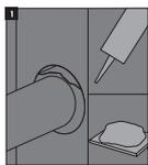
**Selar a abertura:** o espaço anelar à volta do tubo é preenchido com argamassa de gesso (parede de gesso cartonado) ou argamassa de cimento (parede/piso de betão) na espessura total de parede/piso ou, em alternativa, selar com uma espessura mínima de 25mm de Vedante Acrílico Anti-fogo Hilti CFS-S ACR de ambos os lados. Neste último caso, o enchimento com lã de rocha poderá ser omitido em caso do espaço anelar ser pequeno e classificação de resistência ao fogo menor ou igual a EI 120.
