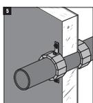
a) Colocar os ganchos de ancoragem na abraçadeira metálica.
