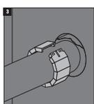
**Fechar a abraçadeira intumescente Hilti:** colocar a Abraçadeira Intumescente Hilti à volta do tubo plástico e aplicar uma pressão firme com a mão até ao encaixe correto induzido pelo "click". Não são necessárias ferramentas, pinos ou parafusos de qualquer tipo. A Abraçadeira Intumescente Hilti pode ser reaberta pressionando no sentido descendente a patilha de encaixe com uma chave de fendas, enquanto puxa a Abraçadeira Intumescente Hilti no sentido da sua abertura.
