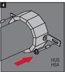
**Colocação dos ganchos de ancoragem:** os ganchos de ancoragem podem ser colocados em vários pontos da abraçadeira metálica. Deverão ser colocados o tão simétricos quanto possível. O número necessário de ganchos é indicado abaixo e na respetiva embalagem.
