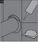
**Selar a abertura:** o espaço anelar à volta do tubo é preenchido com argamassa de gesso (parede de gesso cartonado) ou argamassa de cimento (parede/piso de betão) na espessura total de parede/piso ou, em alternativa, selar com uma espessura mínima de 25 mm de Vedante Acrílico Anti-fogo Hilti CFS-S ACR de ambos os lados. Neste último caso, o enchimento com lã de rocha poderá ser omitido em caso do espaço anelar ser pequeno e a classificação de resistência ao fogo menor ou igual a EI 120.
