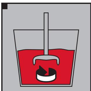
Agite a mistura cuidadosamente com, por exemplo, a pá Hilti TE-MP. Grandes volumes da argamassa anti-fogo Hilti podem ser misturados utilizando máquinas/ misturadoras próprias para o efeito.
