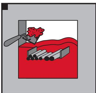
Aplique a argamassa de um ou ambos os lados de grandes aberturas. As aberturas em pisos deverão ter uma estrutura de cofragem por baixo. Aplique a mistura de argamassa na abertura com uma espátula de argamassa ou com uma bomba e compacte-a. Assegure-se de que todas as aberturas e espaços são completamente preenchidos e fechados. Alise a superfície
