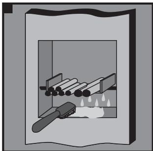
Limpar e humedecer a superfície. Os cabos e as estruturas de suporte devem estar secos e livres de pó, gorduras e óleos e ser instalados de acordo com as normas locais de construção
