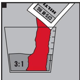
Adicione a Argamassa Anti-fogo Hilti CFS-M RG a água num rácio de aproximadamente de 2,5:1 (argamassa para água em peso). Este rácio determina a consistência (rigidez), recomendada: 2,5:1 para aplicação à mão até um máximo de 2:1 para bombas de projeção.
