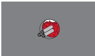
**Inserir fibra de lã mineral.** Deixar espessura suficiente para aplicação do CFS-IS.
